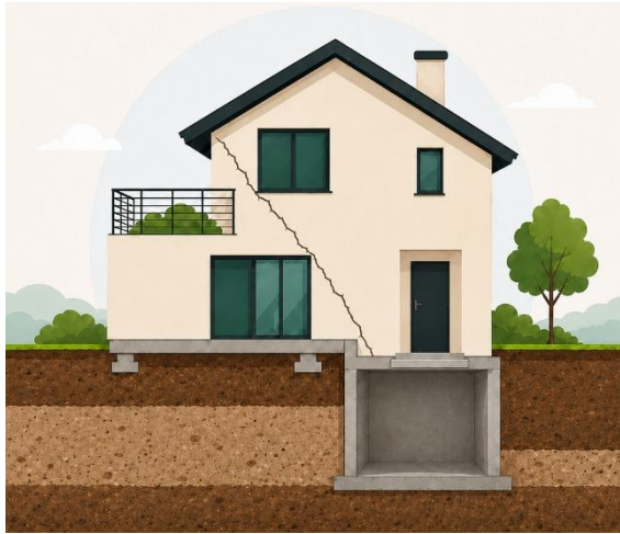
CIMENTACIÓN EN DOS NIVELES
