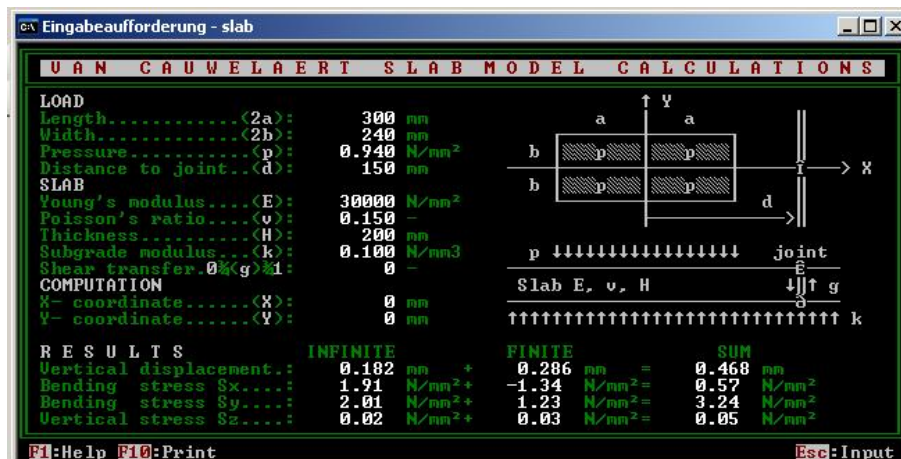
Abb. 8: Spannungen und Verformung bei Belastung einer 20 cm dicken Betonplatte auf Expansionsharz mit einem Bettungsmodul von k = 0,1 und einer Radlast von (5,5 \times 1,2 = ) 6,6 Tonnen
